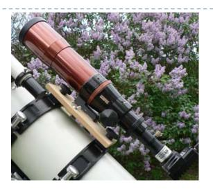
Le capteur de guidage doit être bien aligné selon les axes de la monture
